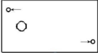
**方法 1:** 用 2 个螺钉支撑 HF5, 2 个胀紧螺栓, 2 个橡胶圈。壳体的底部有 2 个螺丝盲孔 (如图) 在底部。根据 HF5 提供的尺寸, 墙上钻孔, 并放进胀紧螺栓。在每个螺钉上放上橡胶圈, 然后拧紧。
