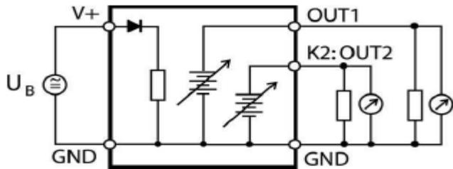
最大允许电缆长度取决于压降情况—环路内设备连接的电流。电缆的压降不仅取决于电缆内阻，也取决于并联到回路的设备的电阻。每个回路的总电阻消耗至少 1000 欧。电缆内阻应不大于 1/1000 的负载电阻。
