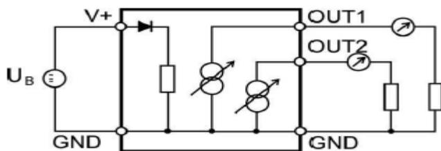
该环路与其他设备相连接，最大允许电缆长度取决于增加电缆的内阻和连接环路的不同设备的电阻组成的总电阻。该电阻不应超过 500 欧姆。
