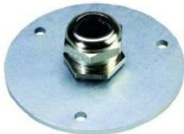
**QMA-15** 是由安装片和耐压接头组成, 该设计是用于 HF5 管道型穿过墙面固定探头 (见附件)。HF5 无需其他辅助支持。
