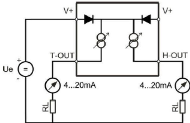
该环路与其他设备相连接, 最大允许电缆长度取决于增加电缆的内阻和连接环路的不同设备的电阻组成的总电阻。该电阻不应超过 500 欧姆。
